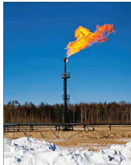
Сжигание попутного газа на факеле
